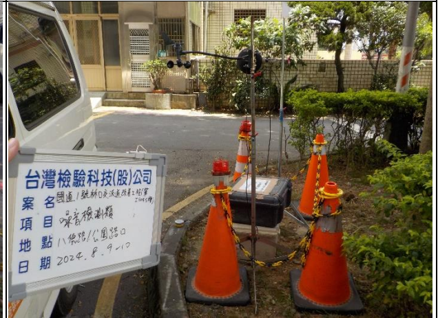
監測項目：環境噪音振動 監測日期：2024.08.09~10 監測地點：八德路/公園路口
